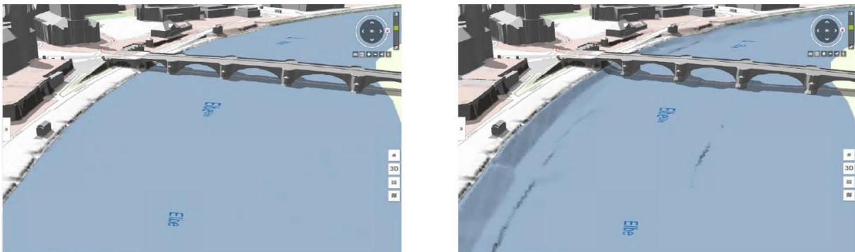
Abbildung 10: Elbe und Augustusbrücke ohne (links) und mit Bathymetrie (rechts)
